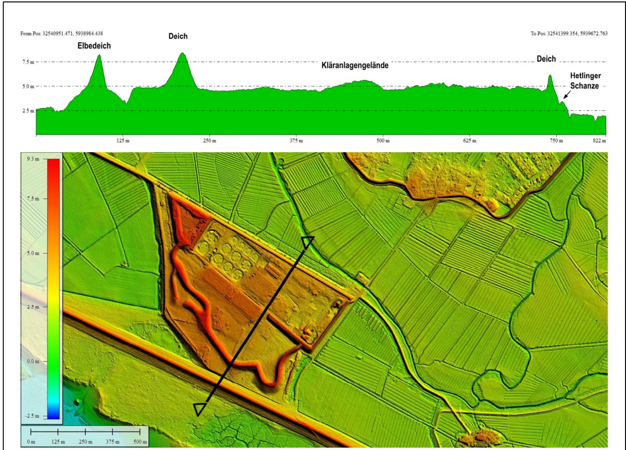
Abb. 3: Geländeschnitt Detail Kläranlage
